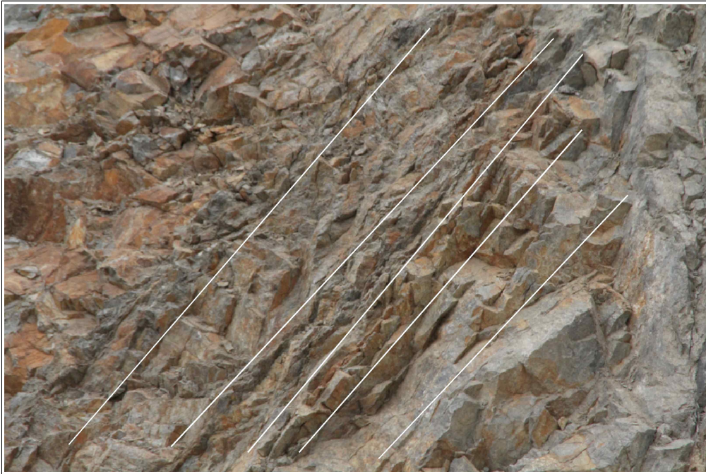
【그림 20】 A 영역 상세사진 (조밀하게 발달한 불연속면)
