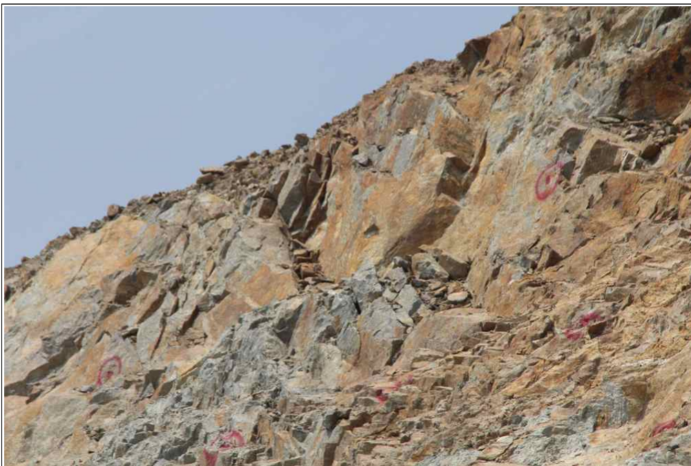
【그림 16】 고각의 불연속면 발달
