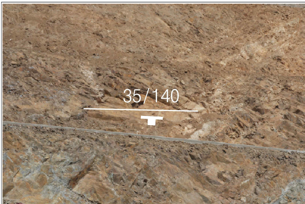
【그림 33】 C 영역에 발달한 불연속면
