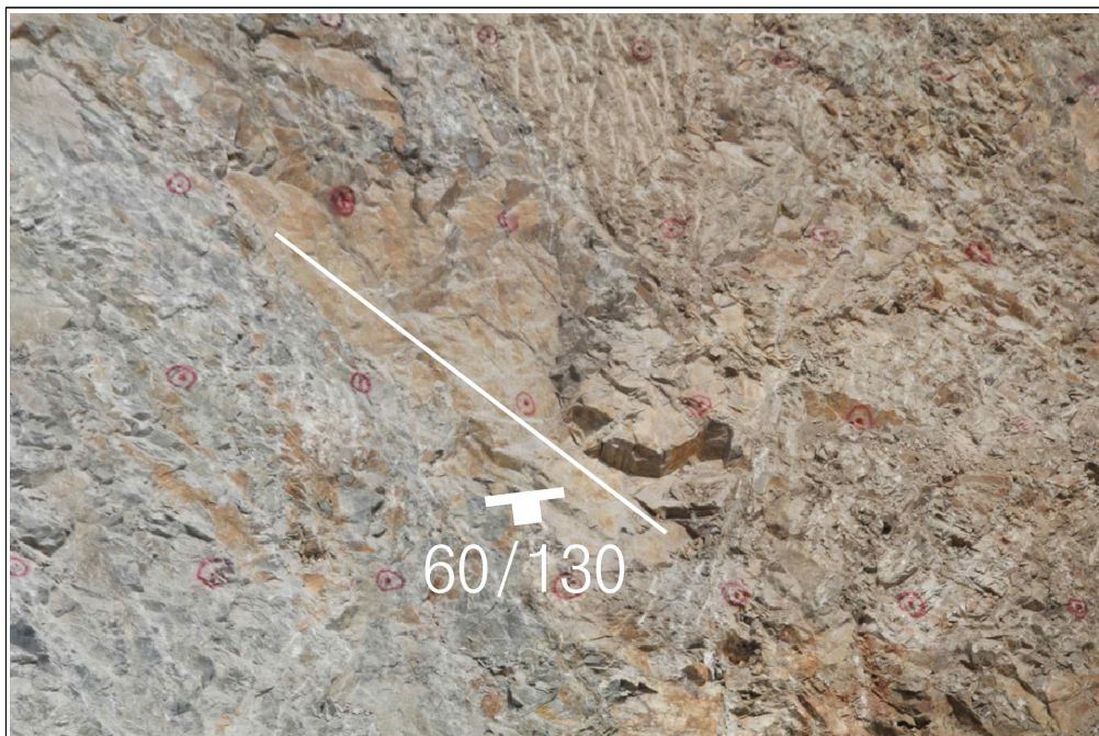
【그림 42】 D 영역에 발달한 불연속면
