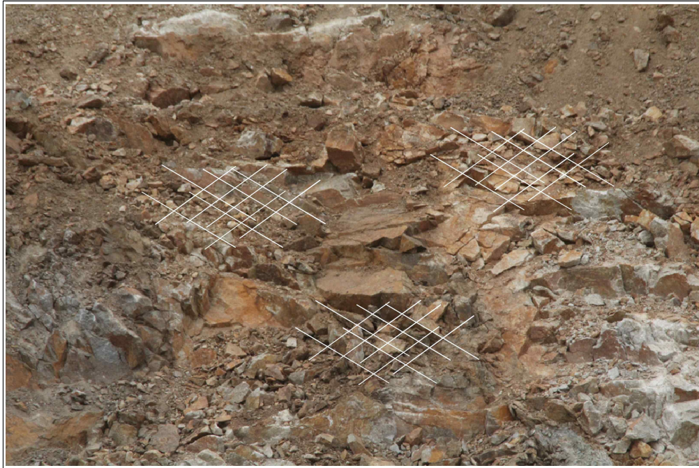
【그림 22】 A 영역 상세사진 (세편화된 암석)
